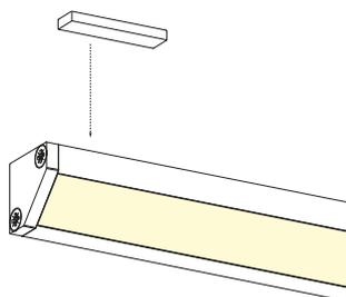
Magneti da incollare per il fissaggio su superfici lisce ferrose.
