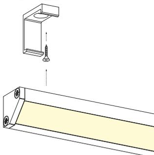
Clip in policarbonato trasparente dotata di vite M2,5x12 per il fissaggio a plafone su svariate superfici aderente alla superficie. Vite M2,5x12 inclusa.
