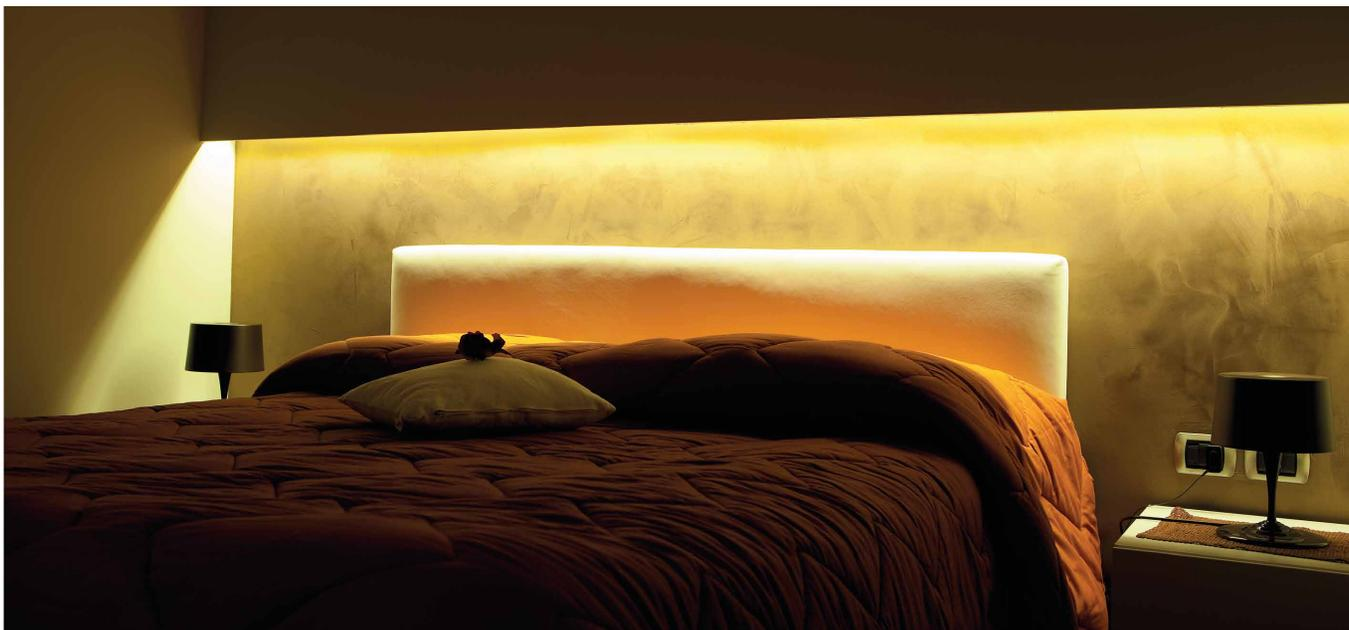
Lampada in alluminio anodizzato decorata completa di diffusore satinato a pressione, supporti laterali e sorgente LED con elevato rapporto Lumen/Watt. Emissione della luce a 45°, possibilità di integrare a bordo profilo sistema on/off Touch. Adatta per illuminazione sotto pensile, arredi, velette ed illuminotecnica in genere. Montaggio con clip a vite o magneti.
