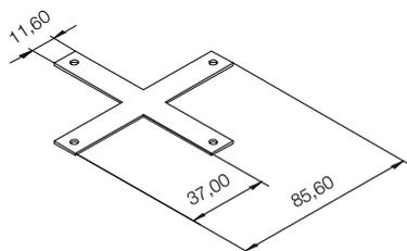
Staffa esterna in acciaio per creare un raccordo a "X". In questa configurazione i profili subiscono una lavorazione di asportazione di materiale per avere un effetto ottico finale impeccabile. Grani M3x4 inclusi.
