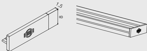
Supporto laterale di chiusura. Realizzato in ABS o Policarbonato. Semplice e compatto per non disturbare le linee nette del profilo.
