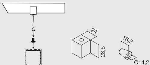
Kit di fissaggio a sospensione completo di fune 3000mm Ø1,2mm.
