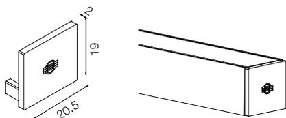
Supporto laterale di chiusura realizzato in alluminio. Montaggio semplice e veloce mediante leggera pressione laterale.
