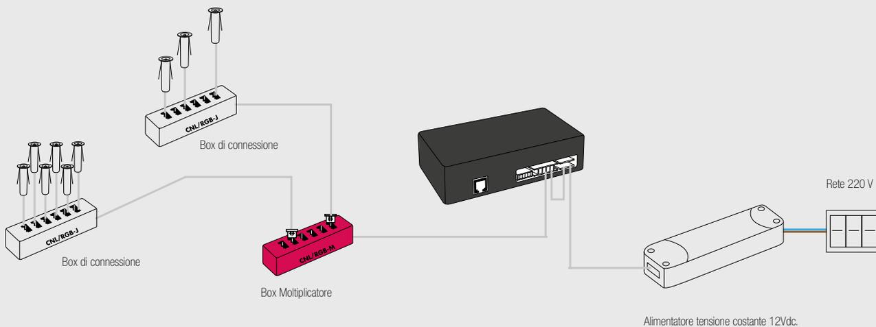
Box per connessione in Serie/Parallelo esclusivamente ed obbligatoriamente di MICROSPOT DUST, SKY e STAR. Disponibile in unica versione a 6 posizioni. Possibilità di connessione multipla con moltiplicatore CNTG/M. NOTE: Collegare solo gruppi da 3 o 6 Microspot. Corrente massima: 2,5A.
