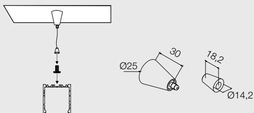
Kit di fissaggio a sospensione con accessorio conico completo di fune 3000 mm  $\varnothing$ 1,2 mm. Grazie al kit si ha la possibilità di regolare la distanza della lampada dal soffitto.
