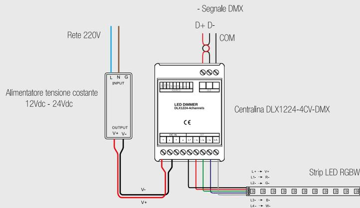
Controllo Strip LED RGBW con Amplificatore
