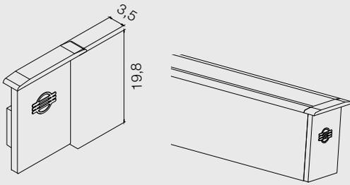
Supporto laterale di chiusura. Realizzato in ABS o Policarbonato.
