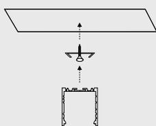
Clip in acciaio per fissaggio a scatto su superfici piane. La clip si aggancia sulle asole posteriori del profilo che risulterà perfettamente aderente alla superficie. Vite M2,5x12 inclusa.
