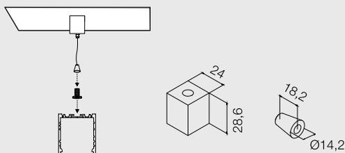
Kit di fissaggio a sospensione completo di fune 3000mm Ø1,2mm.
