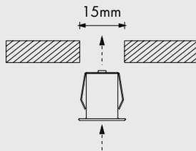
Clip in acciaio per fissaggio ad incasso. Grazie alla molla da installare sul retro del profilo è possibile creare un'ottima tenuta su pannelli di cartongesso o legno.
