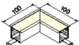
Il raccordo a "L" è stato studiato come terminale tra due profili che si vanno ad intersecare. La linea di luce non subisce interruzioni grazie alla strip LED che corre anche all'interno del raccordo. Con i raccordi per il profilo Tau si apre la possibilità di creare pattern geometrici e giochi di luce coplanari. Grano M3x4 per il fissaggio della staffa lineare compreso.
