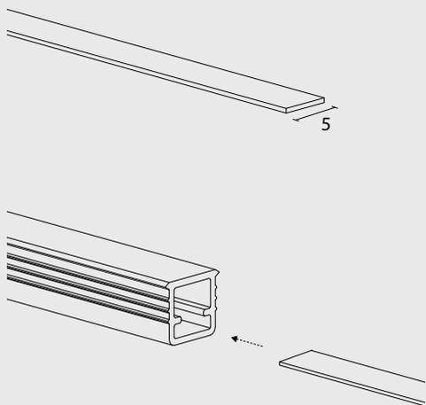
Linguetta in alluminio installabile ad infilare.
