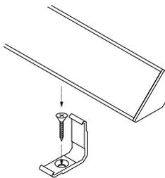
Clip trasparente dotata di vite M2,5x12 per il fissaggio in appoggio su svariate superfici.
