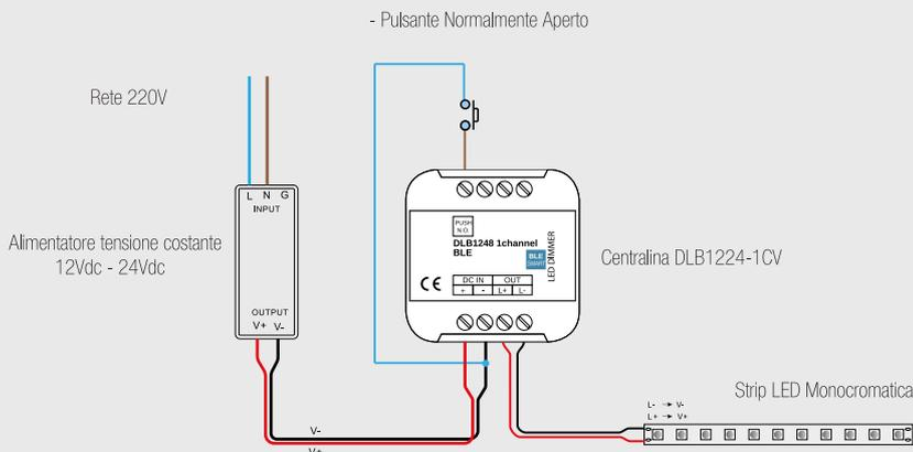
Controllo Strip LED Monocromatiche con amplificatore
