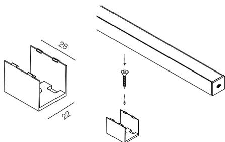
Clip di fissaggio a plafone per il profilo RHO, realizzata in policarbonato trasparente.
