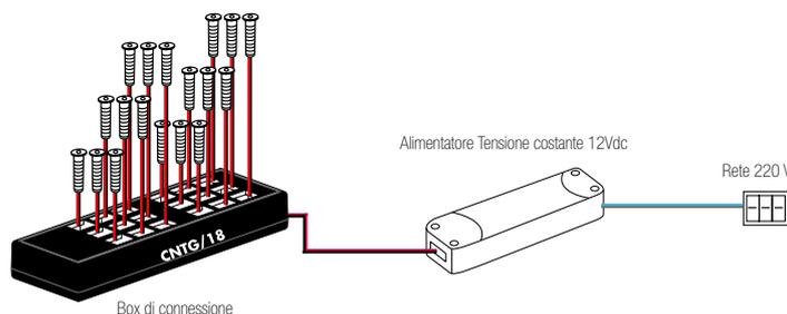
Box per connessione in Serie esclusivamente di POWER LED. Disponibile in tre versioni: 3, 4 o 6 posizioni. Dimensioni ridotte, possibilità di connessione multipla in Serie. Valido accessorio per facilitare l'installazione e per rispettare la polarità e la serie degli impianti con POWER LED. Corrente massima 2,5A.
