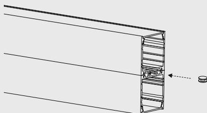
Tiges di ottone per unione del profilo Delta. Accoppiare due profili Delta e con una lieve pressione spingere la tiges di unione nel binario posteriore del profilo.
