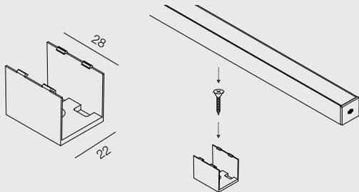
Clip di fissaggio a plafone per il profilo YPSILON, realizzata in policarbonato trasparente.
