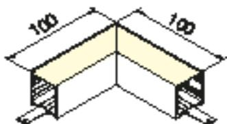
Il raccordo a "L" è stato studiato come terminale tra due profili che si vanno ad intersecare. La linea di luce non subisce interruzioni grazie alla strip LED che corre anche all'interno del raccordo. Con i raccordi per il profilo Delta si apre la possibilità di creare pattern geometrici e giochi di luce coplanari. Grano M3x4 per il fissaggio della staffa lineare compreso.
