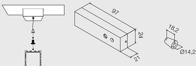
Kit di fissaggio a sospensione completo di fune 3000 mm  $\varnothing$ 1,2 mm.
