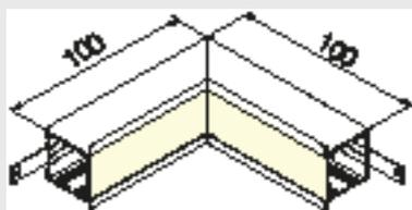
Il raccordo a "L" verticale è stato studiato come terminale tra due profili che si vanno ad intersecare verticalmente. La linea di luce non subisce interruzioni grazie alla strip LED che corre anche all'interno del raccordo. Con i raccordi per il profilo Tau si apre la possibilità di creare pattern geometrici e giochi di luce coplanari. Grano M3x4 per il fissaggio della staffa lineare compreso.
