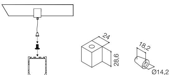
Kit di fissaggio a sospensione completo di fune 3000 mm  $\varnothing$ 1,2 mm. Grazie al kit si ha la possibilità di regolare la distanza della lampada dal soffitto.
