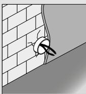
Effettuare il passaggio dei cavi attraverso il tubo elettrico. Eseguire il collegamento secondo lo schema e inserire il faretto applicando una leggera pressione.
