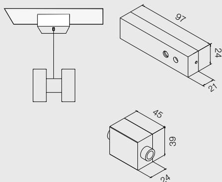
Kit di fissaggio a sospensione per realizzare lampade con doppio profilo distanziati 45mm l'uno dall'altro. Completo di fune 3000mm Ø1,2mm e dadi di fissaggio.
