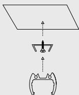
Clip in acciaio per fissaggio a scatto su superfici piane. La clip si aggancia sulle asole posteriori del profilo che risulterà perfettamente aderente alla superficie. Vite M2,5x12 inclusa.
