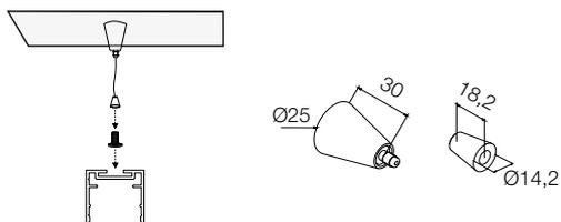
Kit di fissaggio a sospensione con accessorio conico completo di fune 3000mm Ø1,2mm. Grazie al kit si ha la possibilità di regolare la distanza della lampada dal soffitto.
