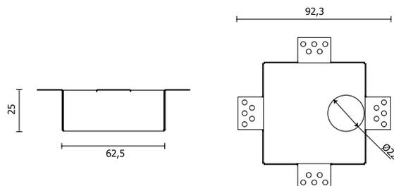
Effettuare una fessura delle dovute direzioni dove inserire la cassaforma e fissarla con viti autofilettati.
