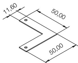
Staffa esterna in acciaio per fissaggio di 2 profili tagliati a 45°. Grani M3x4 inclusi.
