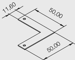
Staffa esterna in acciaio per fissaggio di 2 profili tagliati a 45°. Grani M3x4 inclusi.
