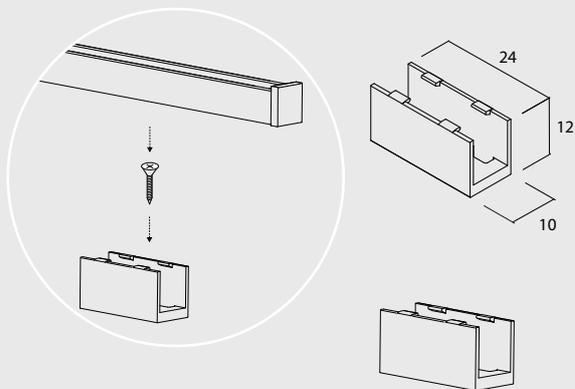
Clip di ssaggio a plafone realizzata in policarbonato.
