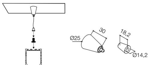
Kit di fissaggio a sospensione con accessorio conico completo di fune 1000mm Ø1,2mm. Grazie al kit si ha la possibilità di regolare la distanza della lampada dal soffitto.
