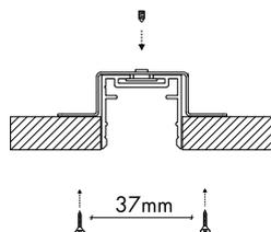
Supporto per il fissaggio ad incasso a raso del profilo Ypsilon. Applicare il supporto sul retro del profilo e fissare al cartongesso da 12mm, tramite viti autofilettanti.
