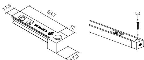
Supporto laterale di chiusura con foro per vite M3X20, capsula di copertura e sensore ad infrarossi on / off.
