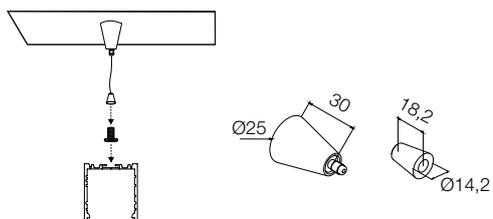
Kit di fissaggio a sospensione con accessorio conico completo di fune 3000mm Ø1,2mm. Grazie al kit si ha la possibilità di regolare la distanza della lampada dal soffitto.
