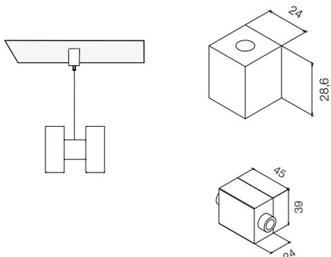
Kit di fissaggio a sospensione per realizzare lampade con doppio profilo distanziati 45mm l'uno dall'altro. Completo di fune 3000mm Ø1,2mm e dadi di fissaggio.
