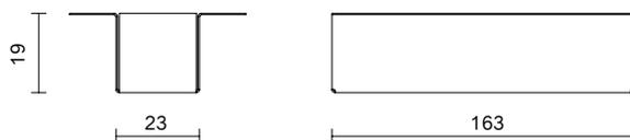
Effettuare una fessura delle dovute direzioni dove inserire la cassaforma e fissarla con viti autofilettanti.
