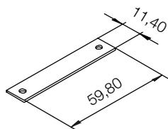
Staffa esterna in acciaio per fissare due profili in linea. Grani M3x4 inclusi.
