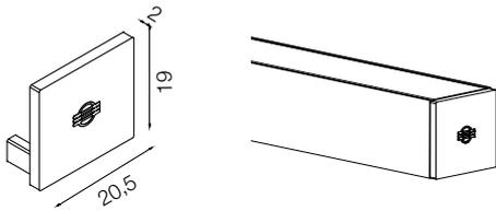
Supporto laterale di chiusura realizzato in alluminio. Montaggio semplice e veloce mediante leggera pressione laterale.
