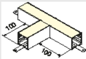
Il raccordo a "T" è stato studiato come terminale tra 3 profili che si vanno ad intersecare. La linea di luce non subisce interruzioni grazie alla strip LED che corre anche all'interno del raccordo. Con i raccordi per il profilo Delta si apre la possibilità di creare pattern geometrici e giochi di luce coplanari. Grano M3x4 per il fissaggio della staffa lineare compreso.
