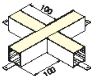
Il raccordo a "X" è stato studiato come terminale tra 4 profili che si vanno ad intersecare. La linea di luce non subisce interruzioni grazie alla strip LED che corre anche all'interno del raccordo. Con i raccordi per il profilo Delta si apre la possibilità di creare pattern geometrici e giochi di luce coplanari. Grano M3x4 per il fissaggio della staffa lineare compreso.
