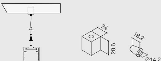
Kit di fissaggio a sospensione completo di fune 3000mm Ø1,2mm.
