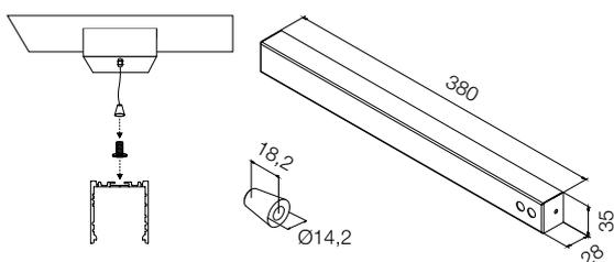
Kit di fissaggio a sospensione completo di fune 3000 mm  $\varnothing$ 1,2 mm. Possibilità di alloggiare un alimentatore al suo interno.
