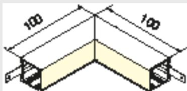
Il raccordo a "L" verticale è stato studiato come terminale tra due profili che si vanno ad intersecare verticalmente. La linea di luce non subisce interruzioni grazie alla strip LED che corre anche all'interno del raccordo. Con i raccordi per il profilo Delta si apre la possibilità di creare pattern geometrici e giochi di luce coplanari. Grano M3x4 per il fissaggio della staffa lineare compreso.
